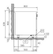
Electrical inlet (power) Equipotential screw
